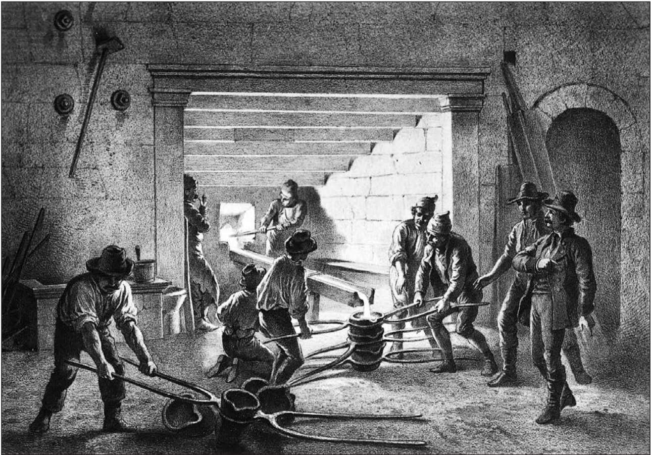
Abb. 8: Guss erster Schmelzung aus einem Gusswerker Hochofen. Gezeichnet und lithographiert von J. Kollarz, gedruckt bei F. Paterno, Wien; 12. Blatt: Maria-Zell/Der Guss.
