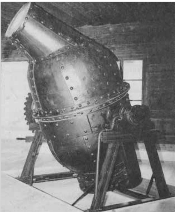
Abb. 11: 1:1-Modell des ersten Bessemerkonverters (1863) im Turracher Stahlwerk; Montan- und Holzmu- seum in Turrach
