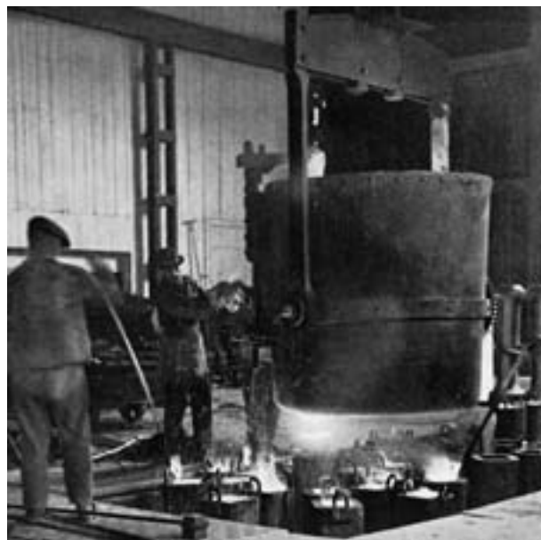
Abb. 23: Rottenmann. Blockguss im Siemens-Martin-Stahlwerk der Rottenmanner Eisenwerke AG, vormals Brüder Lapp, um 1930. Aus Kloepfer, H., und H. Riehl: Das steirische Eisenbuch. Bd. I der Reihe Steirisches Eisen, Beitr. Gesch. des österr. Eisenwesens. Graz 1937, S. 76
