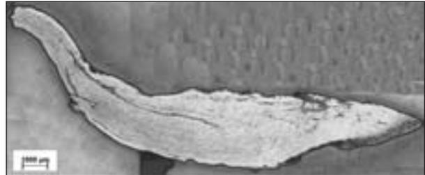
**Abb. 16:** Messerfragment, Depotfund 1, Rabenwand/OG Bad Aussee; Übersicht über das Gefüge der Stahlprobe; Nital-Ätzung.
