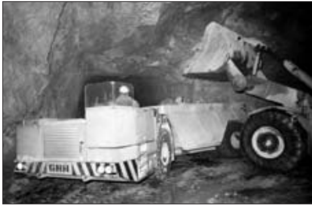
Abb. 17: Beladung Muldenkipper MK30
