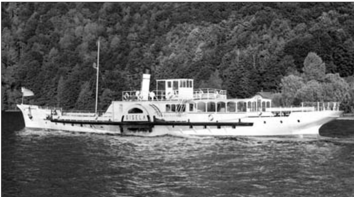
Abb. 4: Traunsee, Oberösterreich: Raddampfer „Gisela“. Erbaut 1871, Antrieb oszillierende Dampfmaschine, bis zuletzt mit Kohlefeuerung betrieben. Denkmalschutz 1981. Technisches Denkmal: Ältestes erhaltenes Dampfschiff in Österreich mit originaler Dampfmaschine (heute auf Ölfeuerung umgestellt). Nach umfangreicher, kostenaufwendiger Restaurierung unter der Patronanz eines engagierten Vereines ist die „Gisela“ nun wieder – bei Sonderfahrten – am Traunsee unterwegs.
