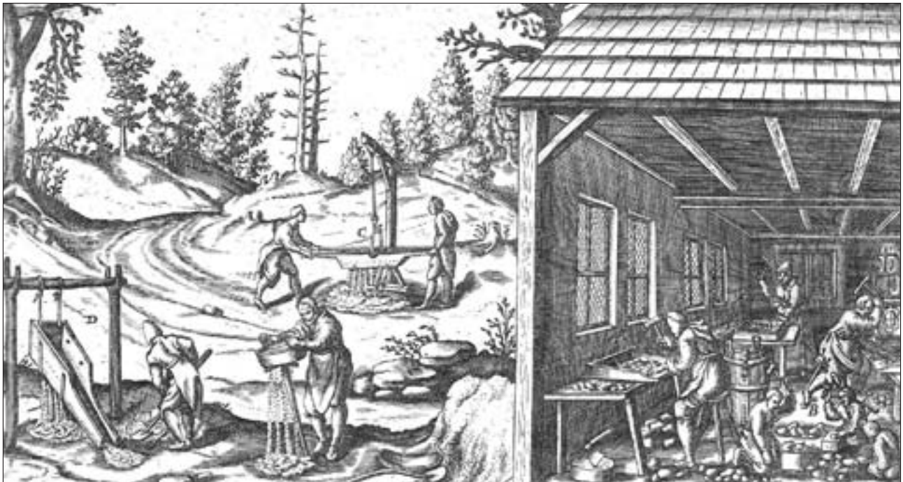
Abb. 3: Scheider beim trockenen Zerkleinern, Klassieren und Sortieren von Erz (Löhneyß, Bericht von Bergwercken, Privatbesitz)
