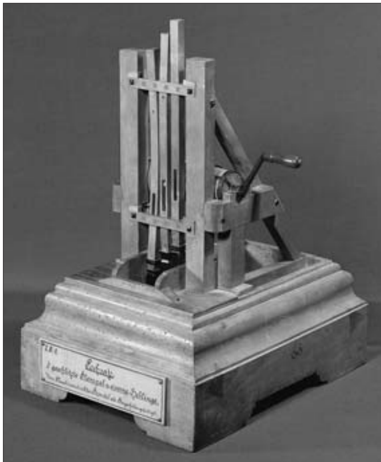
Abb. 6: Modell eines Pochsatzes; der spätere sächsische Maschinenbaumeister Ch. F. Brendel fertigte dieses Modell um 1800 als Schüler an der Freiburger Bergschule. TU Bergakademie Freiberg (Foto: W. Rabich, Dresden)
