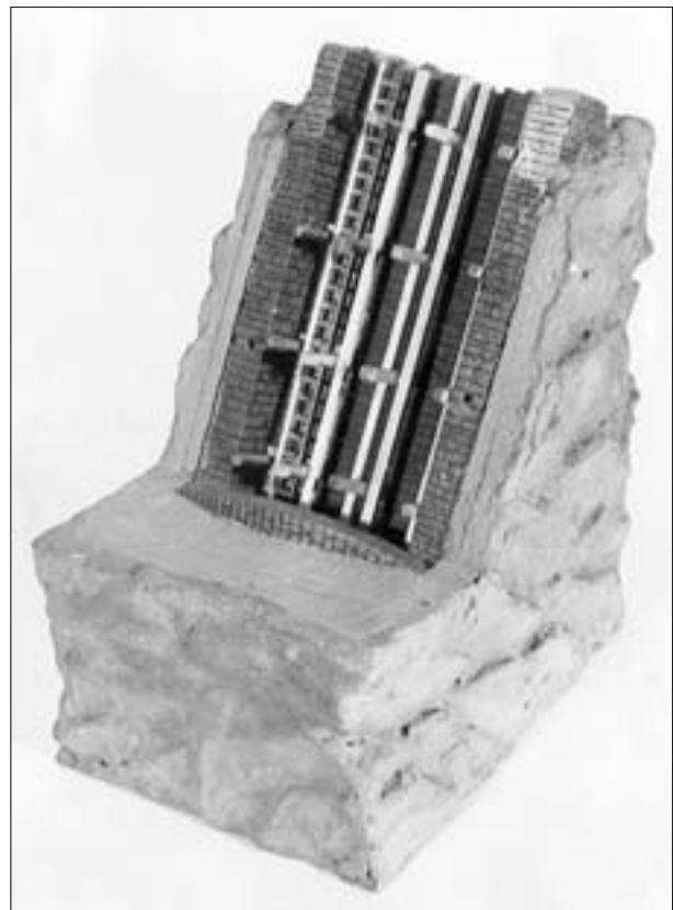
Abb. 10: Modell eines Schachtausbaues von Löscher aus Holz und Pappmache, „nach dem Treibesacht auf dem Schwarzfarbener Spatgang, auf der Beschertglück Fundgrube hinter den drei Kreuzen“, 4 Modelle wurden 1803 für 4 Taler je Stück gekauft. TU Bergakademie Freiberg
