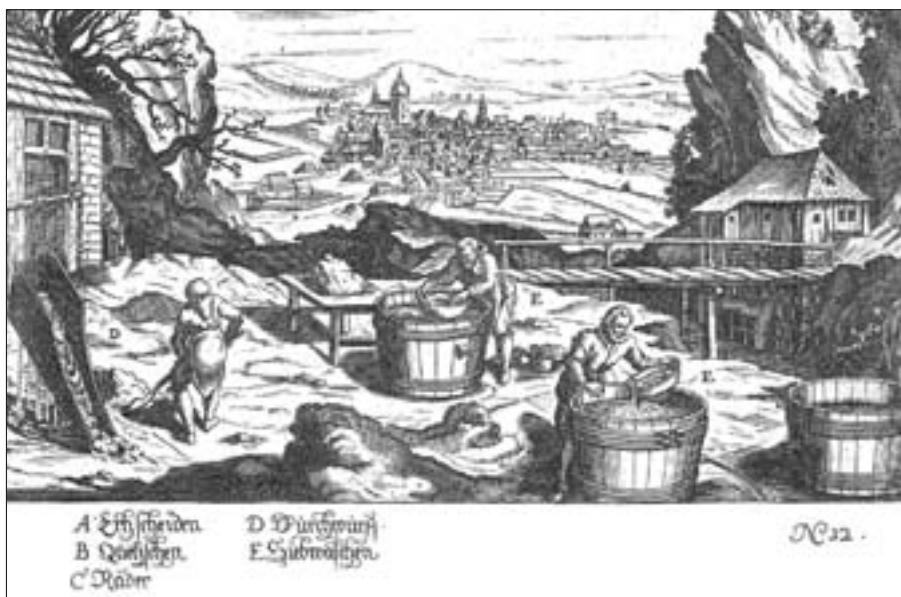
Abb. 1: Scheider beim Klassieren und Sortieren von Erz auf nassem Wege (Löhneßß, Bericht von Bergwercken).
