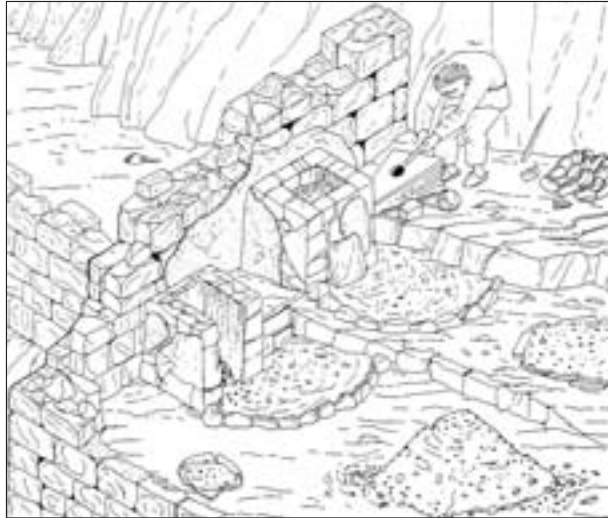
Abb. 9: Auf Basis der Schmelzversuche, die Andreas Brunn (1991) unter Anleitung des Autors 1990 im Areal der Rocca San Silvestro ausführte, wurde ein Schmelzofen zur Kupfererzeugung des 12./14. Jahrhunderts errichtet (Umzeichnung aus: Francovich 1991): Neben dem kleinen Schachtofen ein Ofen mit offener Brust, wie er zum Rösten der Erze gedient haben könnte.
