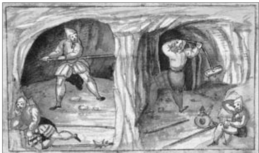
Abb. 4: Durchschlag zwischen nebeneinander liegenden Gruben, Häuer mit Pucher und Renkstange (Faksimileausgabe des Schwazer Bergbuches, Codex 10.852).
