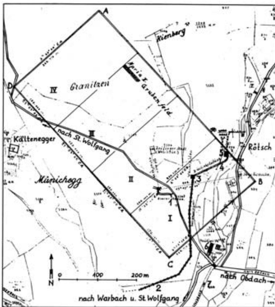
Abb. 5: Kohlenbergbau Obdach. Lagerungskarte des Grubenfeldes „Maria II“ (ABCD) mit vier einfachen Grubenmaßen. Verkleinerter Ausschnitt aus der mit „Leoben am 20. Nov. 1922“ datierten „Maßen-Lagerungskarte des Maria-II-Grubenfeldes in Münichegg bei Obdach“ (Mönchegg) in der Berghauptmannschaft/Montanbehörde Süd Leoben, Aktenbestand Kohlenbergbau Obdach. 1 = Stollen I, 2 = Oberwasserfluter (abgetragene 1985), 3 = Wasserschloss, 4 = Druckrohrleitung, 5 = Elektrizitätswerk, 6 = Pauliwirt, 7 = Granitzenbach
