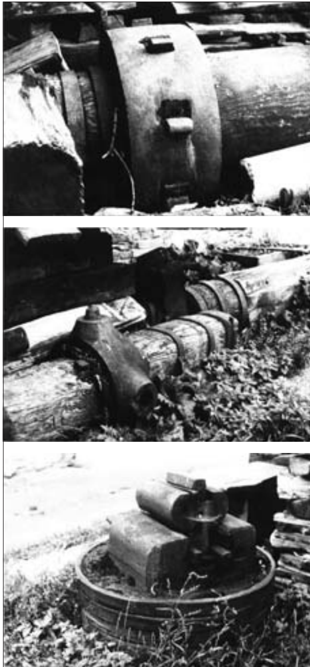
Abb. 21: Demontierter Schwanzhammer bei der Kathal-Schmiede. Oberes Bild: Grindel und Pauke mit Erthn; mittleres Bild: rechts hinten Grindel, links vorne Hammerholm mit Waagring; unteres Bild: Schabotte mit Amboss. Aufnahme: H. J. Köstler, September 1969.
