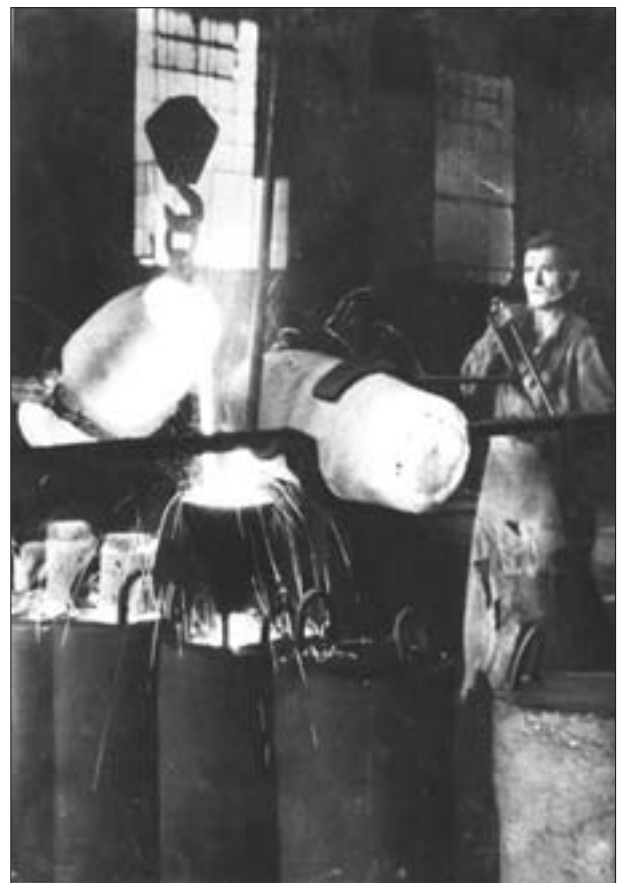
Abb. 14: Entleeren (Gießen) des flüssigen Stahls aus den Tiegeln in Kokillen, wo der Stahl zu „Königen“ erstarrte. Undatierte Aufnahme (unbekanntes Tiegelgussstahlwerk) im Besitz von H. J. Köstler.
