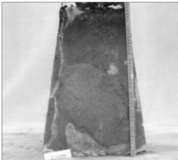
Abb. 4: Untersucher Verschleißfutterstein aus dem „Francisci-Hochofen“ in Möderbrugg.
