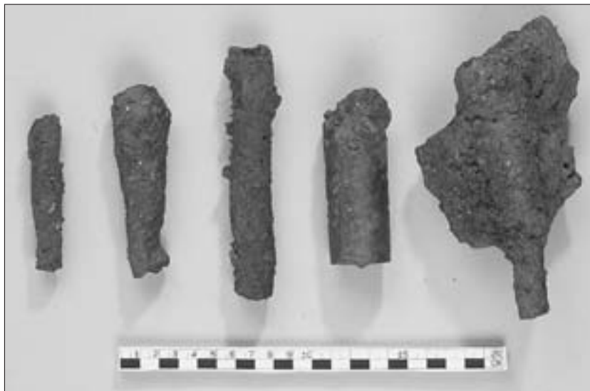
Abb. 8: Kreuztratte, Zapfenschlacken. Foto: N. Sautner.
