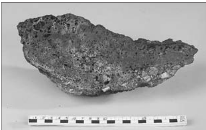
Abb. 10: Kreuztratte, Stahlluppe. Foto: N. Sautner.
