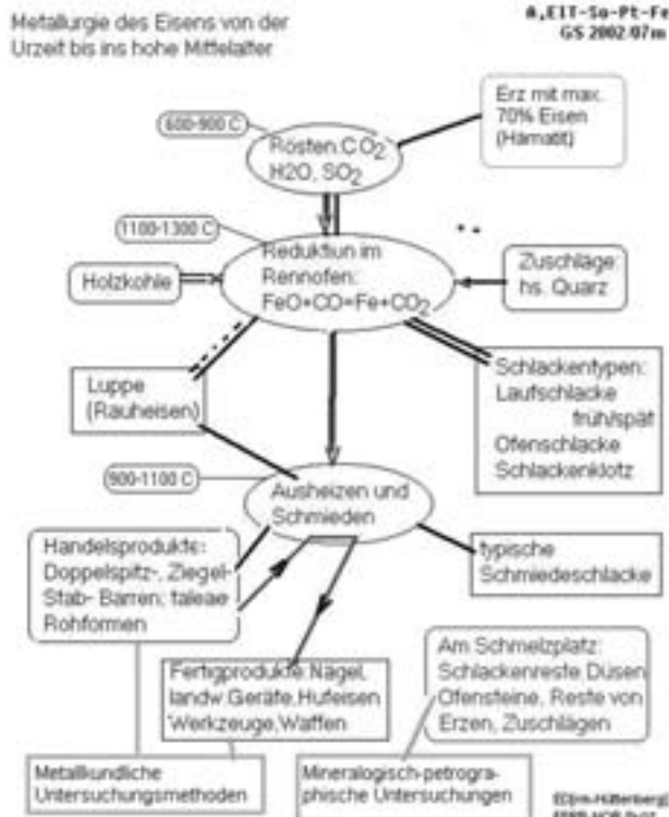
Abb. 3: Die Metallurgie des Eisens im direkten Verfahren zur Herstellung der Rauheisen-Luppe und Methoden der Funduntersuchungen dazu.
