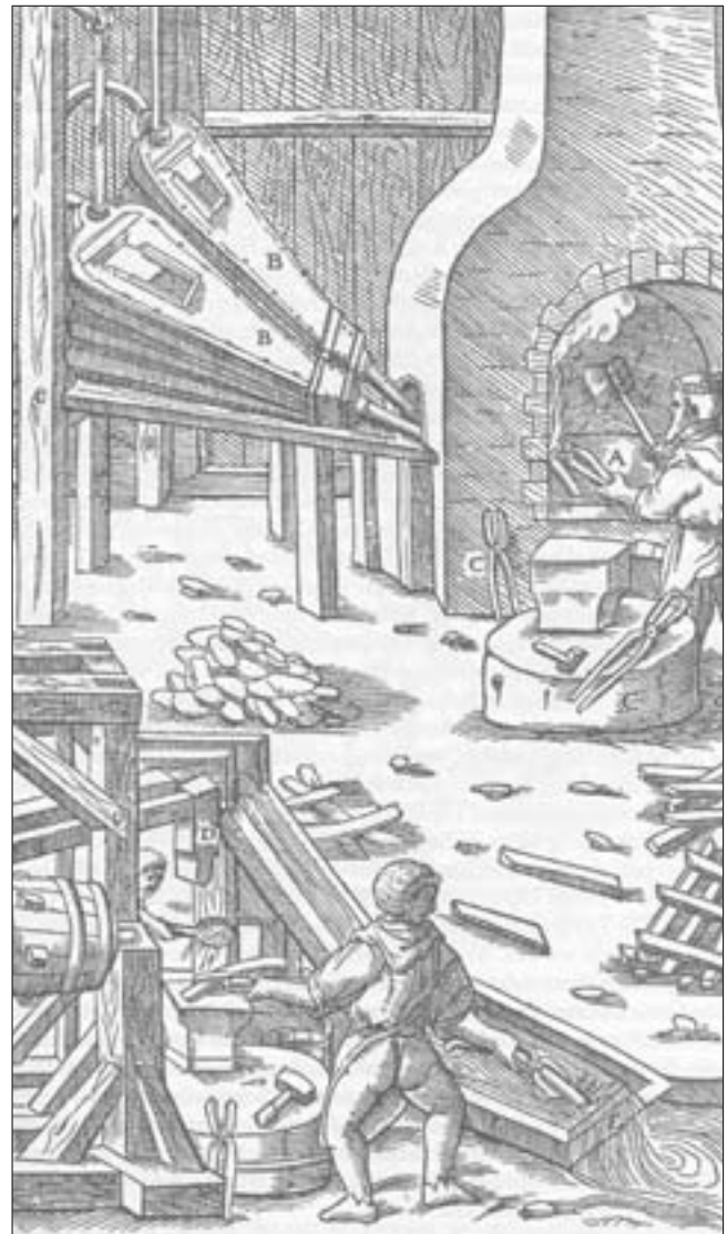
Abb. 6: Georg Agricola (9), das Härten von Stahlstäben in fließendem Wasser.
