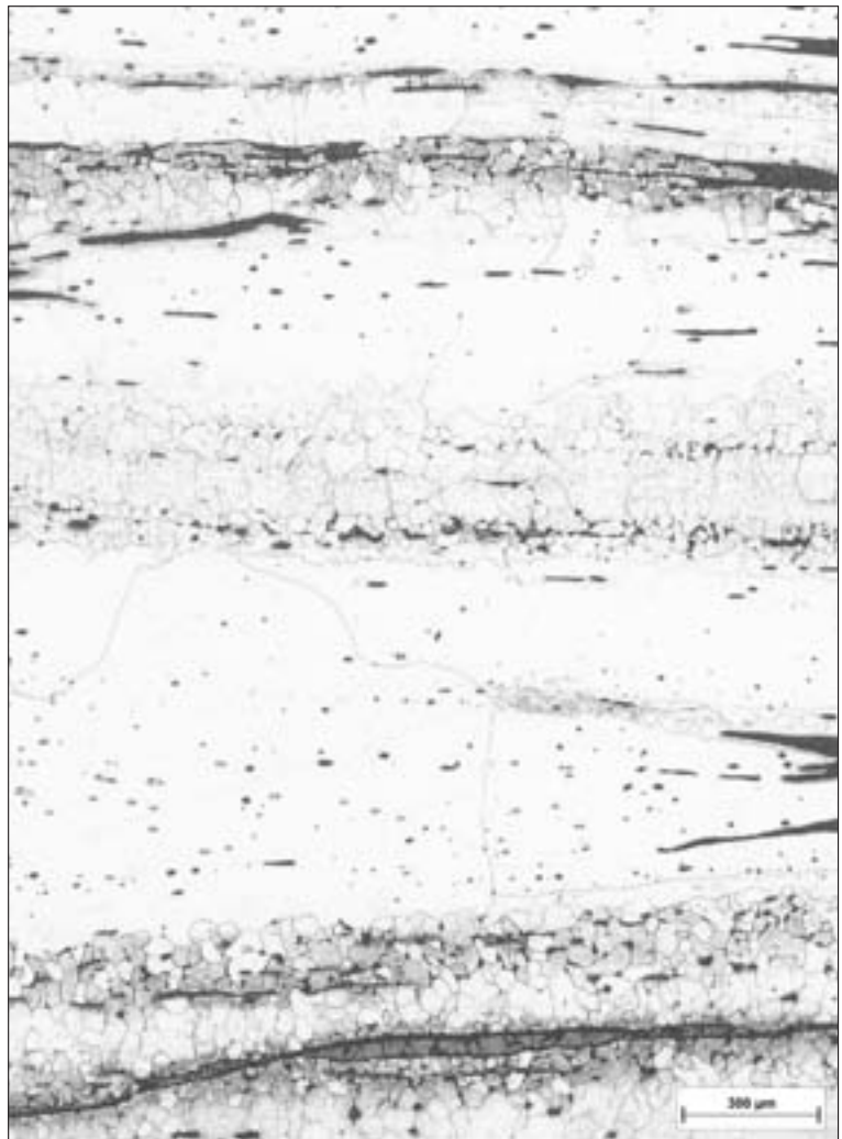
Abb. 3: Tüllenbeil (Ferrite), Probe Nr. 68, Fundort Gründberg, Gemeinde Linz, Österreich. Verschiedene Ferritausbildungen bzw. Anordnungen infolge Verschmiedens von Stahlstäben; Nital-Ätzung.
