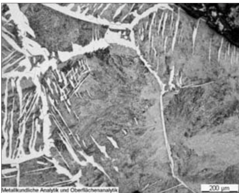
Abb. 11: Kreuztratte, Gefüge der Stahlluppe. Perlit mit Korngrenzenferrit und nadeligem Ferrit (Widmannstättengefüge). Nital-Ätzung.
