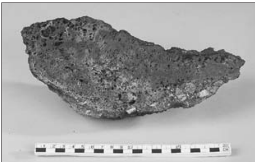
Abb. 10: Kreuztratte, Stahlluppe. Foto: N. Sautner.
