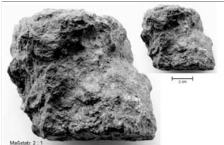
Abb. 1: Makroskopische Aufnahme der Roheisenprobe; Fundort Eisner/Hüttenberg.
