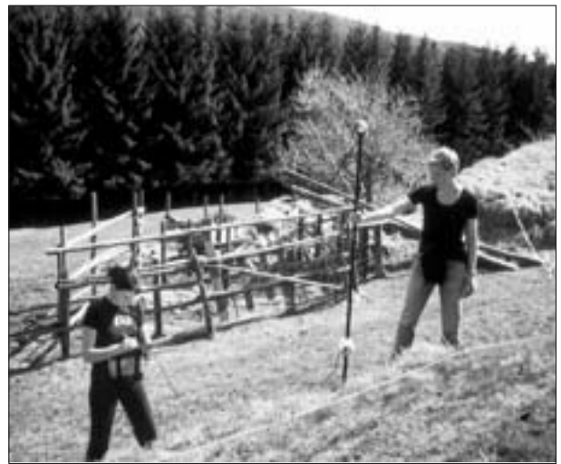
▲ Geomagnetische Kartierung auf der Kreuztratte, Lölling-Sonnseite bei Hüttenberg.
