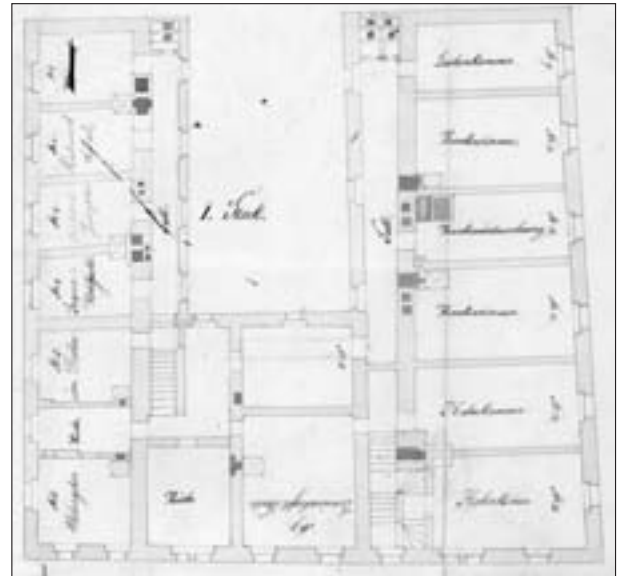
Abb. 3: Grundriss vom ersten Obergeschoss des Kastenhauses in Vordernberg nach einem undatierten Bauplan (nach 1842). Der Plan zeigt deutlich die gemischte Nutzung mit den Räumen zur Lagerung von Hafer und dem dahinter liegenden Krankentrakt im Südflügel (rechts im Bild) und den Arbeiterwohnungen im Nordtrakt. StLa, Markt Vordernberg, Sch 215, H 472.
