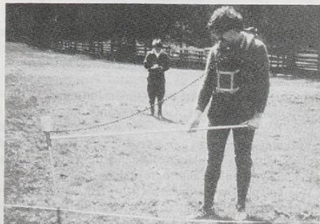
Abb.3: Prospektionsmessung mit einem Magnetometer im Bereich des Kupferverhüttungsplatzes Johnsbach-Griesmeier
