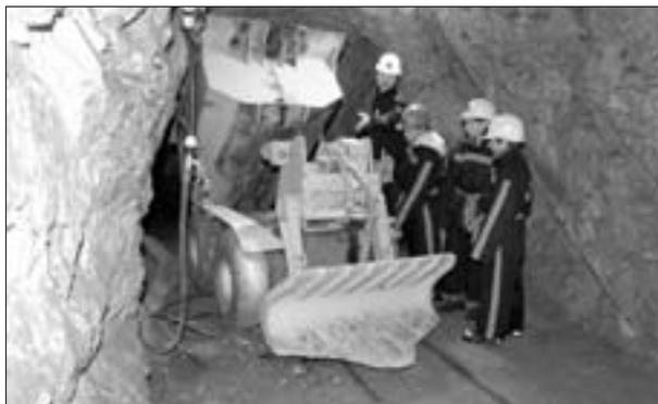
**Abb. 7: Terra Montana: Wurfschaufellader Cavo 310, Atlas Copco. Aufnahme: Wolfgang Rossbacher.**
