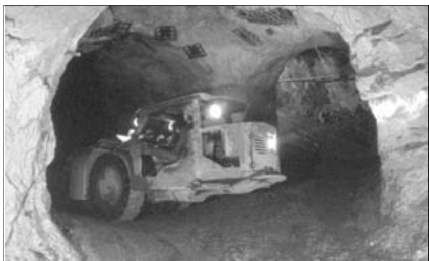
Abb. 19: Abbau-Dieselladegerät Eimco 912 mit 2 m 3 Schaufel im Wendelbereich eines Großraumabbaues (Mitte der 1970er Jahre bis zum Ende des Bergbaubetriebes) (KLA, BBU).
