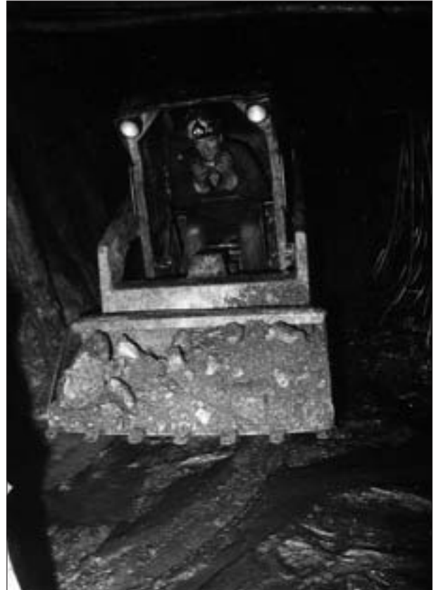
Abb. 5: Gewinnung des Eisenglimmers nach der Sprengarbeit vor Ort und Transport mit dem Radlader zum Füllbunker. Aufnahme: F. Prugger, 1992.
