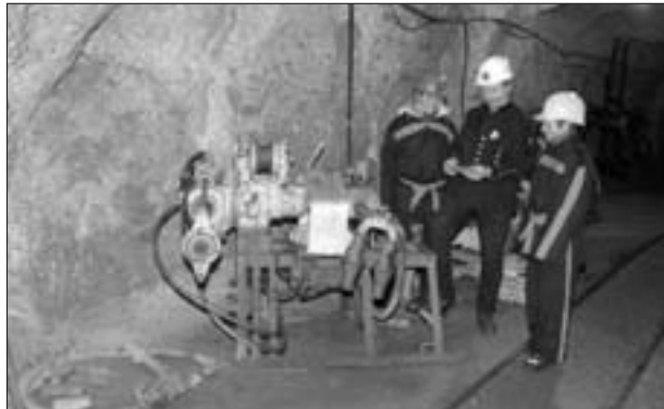
Abb. 5: Terra Montana. Kernbohrmaschine für Probebohrungen zum Auffinden von Erz. Aufnahme: Wolfgang Rossbacher.
