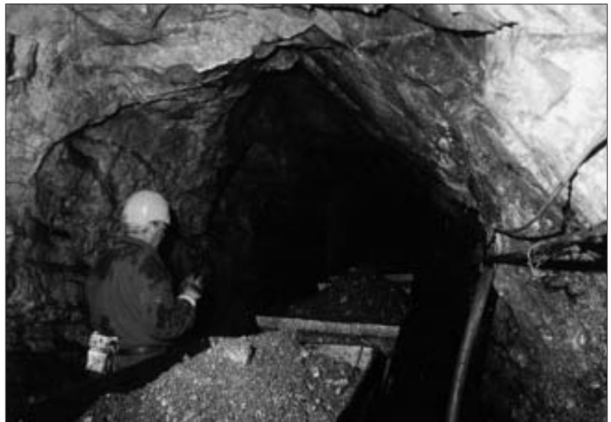
Abb. 6: Transport des Haufwerkes mit Hunten vom Füllbunker zur untertägigen Brecheranlage. Nach der Brechung des Haufwerkes erfolgt der Transport über Vertikal- und Horizontalbandanlagen direkt in die Aufbereitung. Aufnahme: F. Prugger, 1992.
