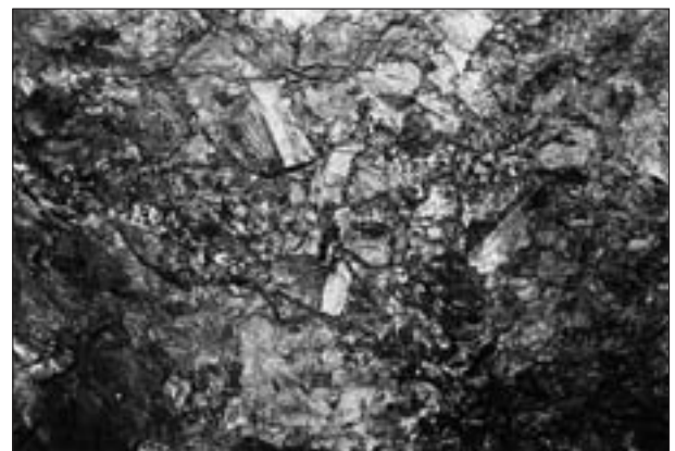
Abb. 13: Polymikte Resedimentbreccie als Erzkörper der Raibler Schichten mit z.T. bereits Sedimentärerz-führenden Raiblerdolomit-Fragmenten (verschieden grau), WD-Fragmenten (weiß), und bereichsweise tonigem Bindemittel (schwarz) aus Raibler Schieferthon.
