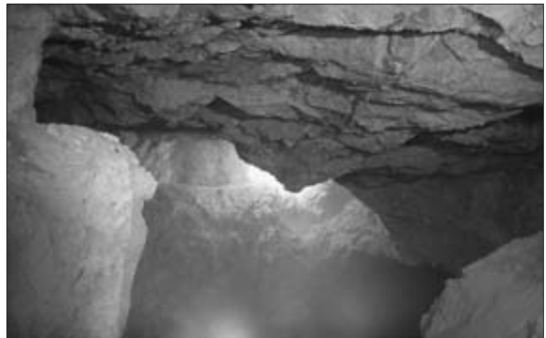
Abb. 8: Blick in einen noch recht kleinen „Abbaukessel“ im System Abbau I im Kienbergrevier des Wilhelm-Erbstollen. Der Durchmesser liegt noch bei etwa 20 m. Links oben der „Weg“, über den der Häuer den Abbauort erreichte. Die höheren Abbauteile gingen am 2.5.1993 zu Bruch.
