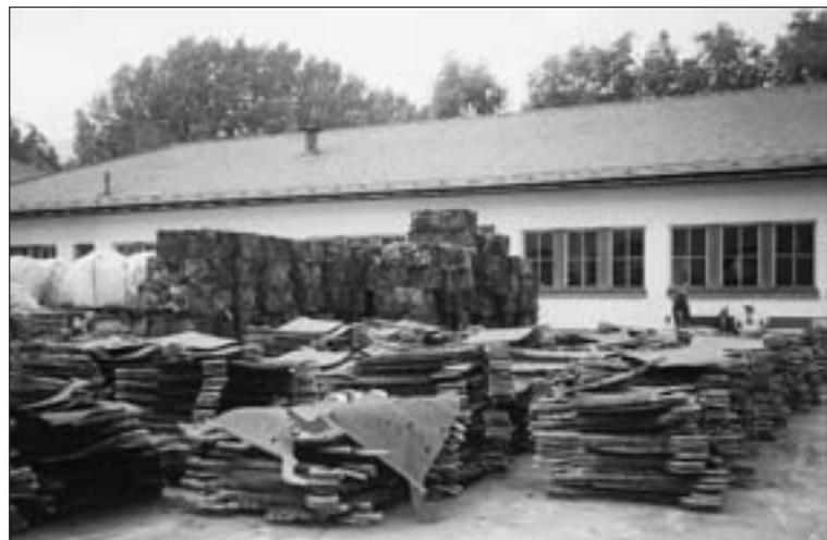
Abb. 7: Kupfervormaterial in der Kupferhütte (Recyclinghütte) in Brixlegg; unbrauchbar gewordene Anoden, paketiierter Schrott usw. Aufnahme: H. J. Köstler, Mai 1997.
