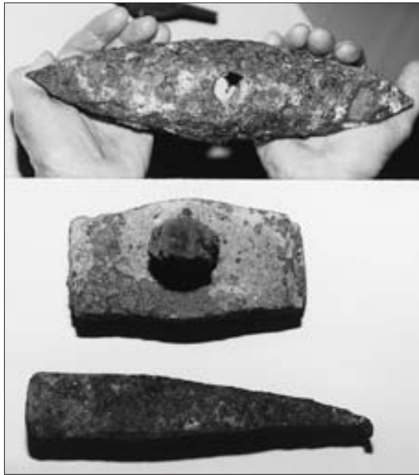
Abb. 8: Werkzeuge, gefunden in Spitzelofen. Doppelseitiger Spitzschlüssel, Hammer und Setzkeil. Sammlung FR DI Christoph Habsburg-Lothringen, St. Andrä/Lavanttal. Foto R. Konopasek, September 2005.
