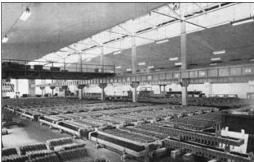
**Abb. 4:** Elektrolyse-Bäder der Kupferhütte in Brixlegg 1963. Aus: *500 Jahre Kupferhütte Brixlegg 1463-1963. Brixlegg 1963.*
