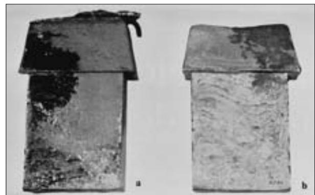
Abb. 11: Kupferbarren, a = reines Kupfer, b = Kupfer mit 5 % Arsen. Lit. Arqueología Mexicana . D. Hosler (ohne Größenangaben). Aufnahme: R. Konopasek, 2005.
