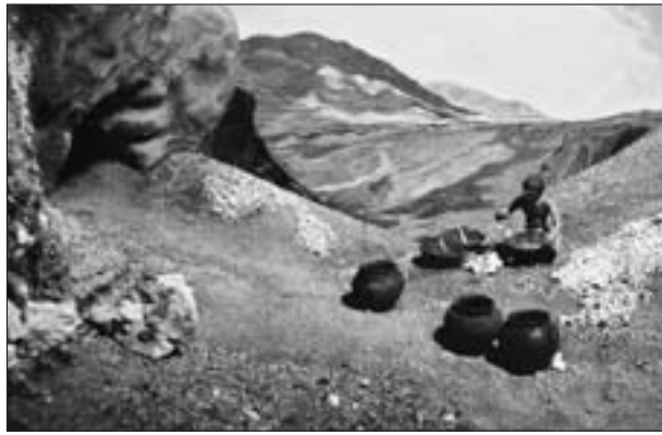
Abb. 7: Anreicherung durch Handklaubung vor dem Grubeneingang. Regionalmuseum von Querétaro. Aufnahme: R. Konopasek, 2003.
