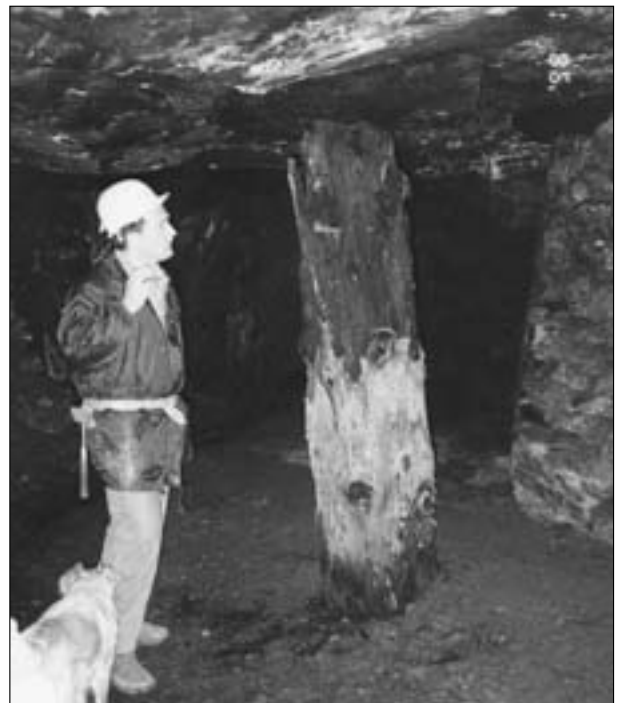
Abb. 11: Eisenerzbergbau in der Ranzen; Stempel in einem ehemaligen Abbaugebiet. Aufnahme: H. J. Köstler, Dezember 2000.
