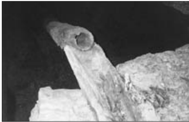
Abb. 12: Holzrohr einer Wasserhaltungsanlage (Pumpenanlage) im Eisenerzbergbau in der Ranzen; Innendurchmesser des Rohres ca. 10 cm. Aufnahme: H. J. Köstler, Dezember 2000.
