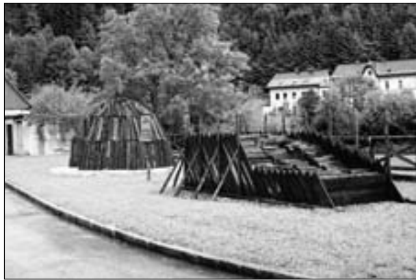
Abb. 2: „Stehender Haufen“ (links) und „Liegendes Werk“; Köhlereimuseum Hieflau an der Steirischen Eisenstraße. Aufnahme: B. Hable, Juni 2004.
