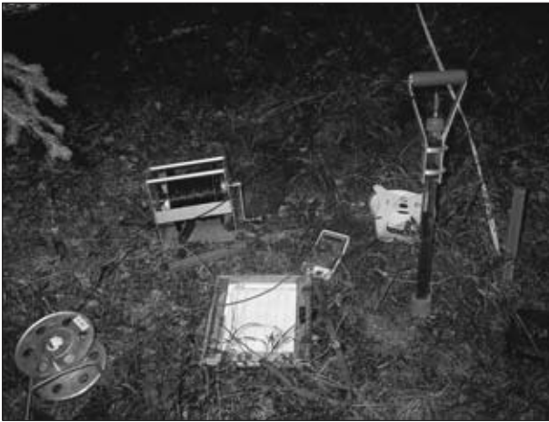
Abb. 4: Messaufbau für Eigenpotenzialregistrierung (Foto Georg Walach).
