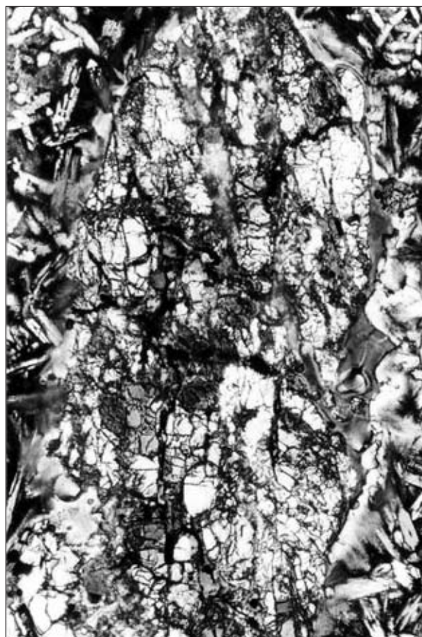
Abb. 1: Großes Quarzkorn in einem Dünnschliff der Schlackeprobe von der „Versunkenen Kirche“. Optische Mikroskopie, Durchlicht, parallele Nicols, 50-fache Vergrößerung.
