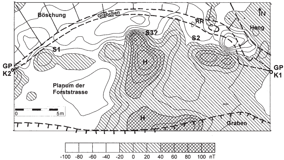
Abb.5: Urzeitliche Verhüttungsanlage Gaishorn, Meilerweg, Ergebnis der geomagnetischen Vermessung (Isanomalienplan)
