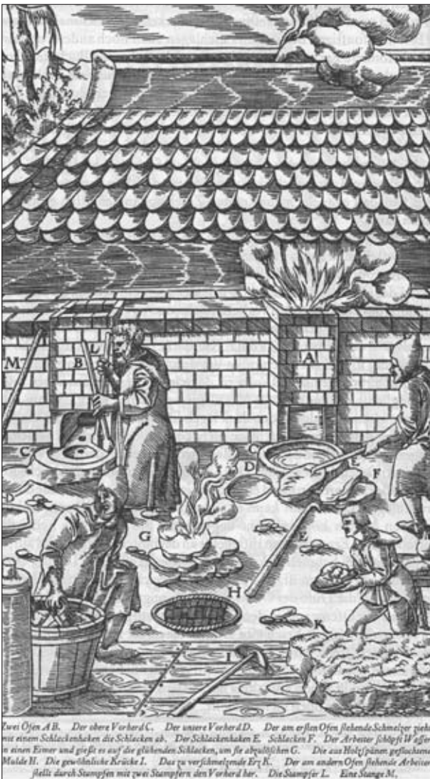
Abb. 5: Norische Hüttenanlage zum Schmelzen edelmetallhaltiger Kupfererze nach Georg Agricola (23).
