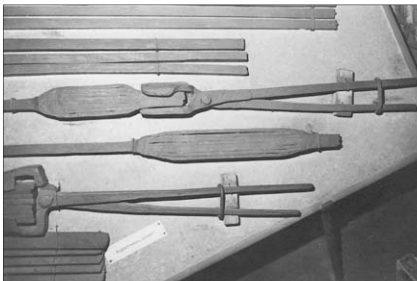
Abb. 4: Herstellung des Gärbstahls. Unten links: Ausgangsmaterial, oben: Gärbstahlstangen. Eisenmuseum (Sensenhammer) im Heimathaus Steyr. Aufnahme: H. J. Köstler, März 1970.
