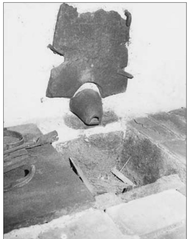
Abb. 2: Gärb- oder Zainfeuer, das bei geänderter Neigung der Blasform auch als Frischfeuer verwendet werden konnte. Hinten: Blasform, davor: Herdgrube. Eisenmuseum (Sensenhammer) im Heimathaus Steyr. Aufnahme: H. J. Köstler, März 1970.
