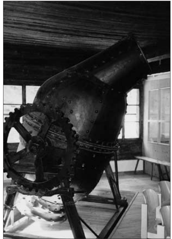
Abb. 14: Bessemerkonverter (1:1-Modell) im Montanmuseum in Turrach, Sept. 2000. Aufnahme: H. J. Köstler
