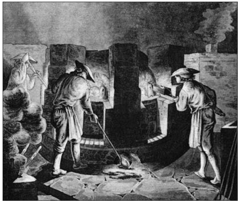
Abb. 3: Das Schmelzen von blauem Farbglas aus Kobalterzen (aus Winckler 1959).
