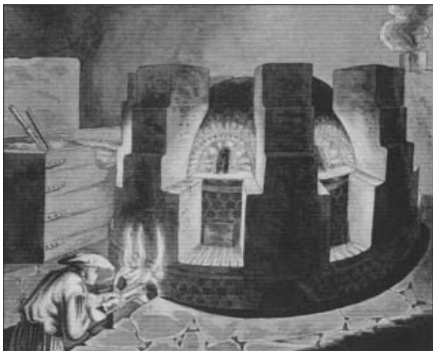
Abb. 5: Ofen zur Herstellung von Kobaltglas – „Smalte“ (aus: A. F. WINKLER, 1790).
