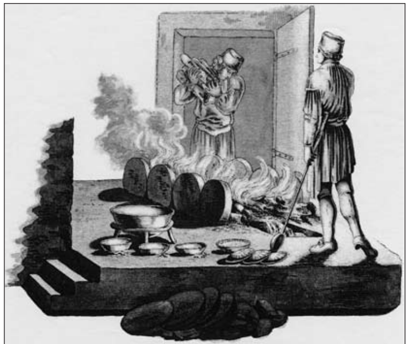
Abb. 4: Aussaigern von Wismutmetall aus den Rückständen der Kobaltfarbherstellung (aus Winckler 1959).
