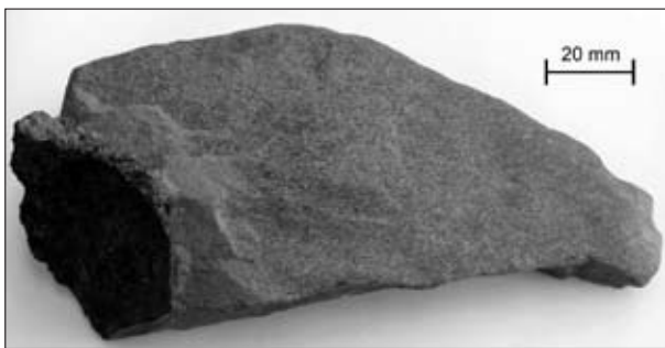
Abb. 6: Verhüttungsplatz Versunkene Kirche, Gemeinde Trieben; verschlackter Ofenstein aus der mittleren Ofenwand des Schachtofens – bevorzugtes Steinformat
