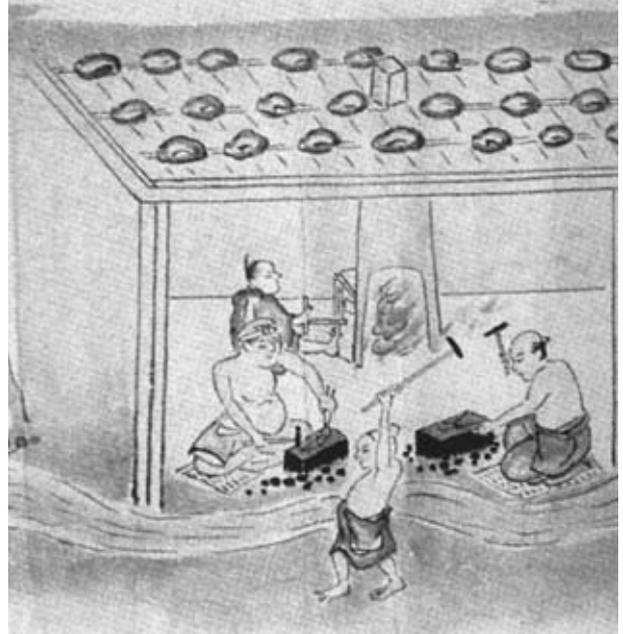
Abb.8: Bergschmiede bei der Arbeit, links der Esse der Gehilfe am Gebläse
