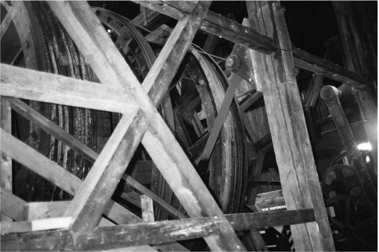
**Abb. 10:** Wismath-Aufzug, neuer Aufstellungsort am Gloriette-Rücken. Zwischen den beiden Seiltrommeln die als Bandbremse konstruierte Notbremse (Foto: Alfred Weiß 1998).
