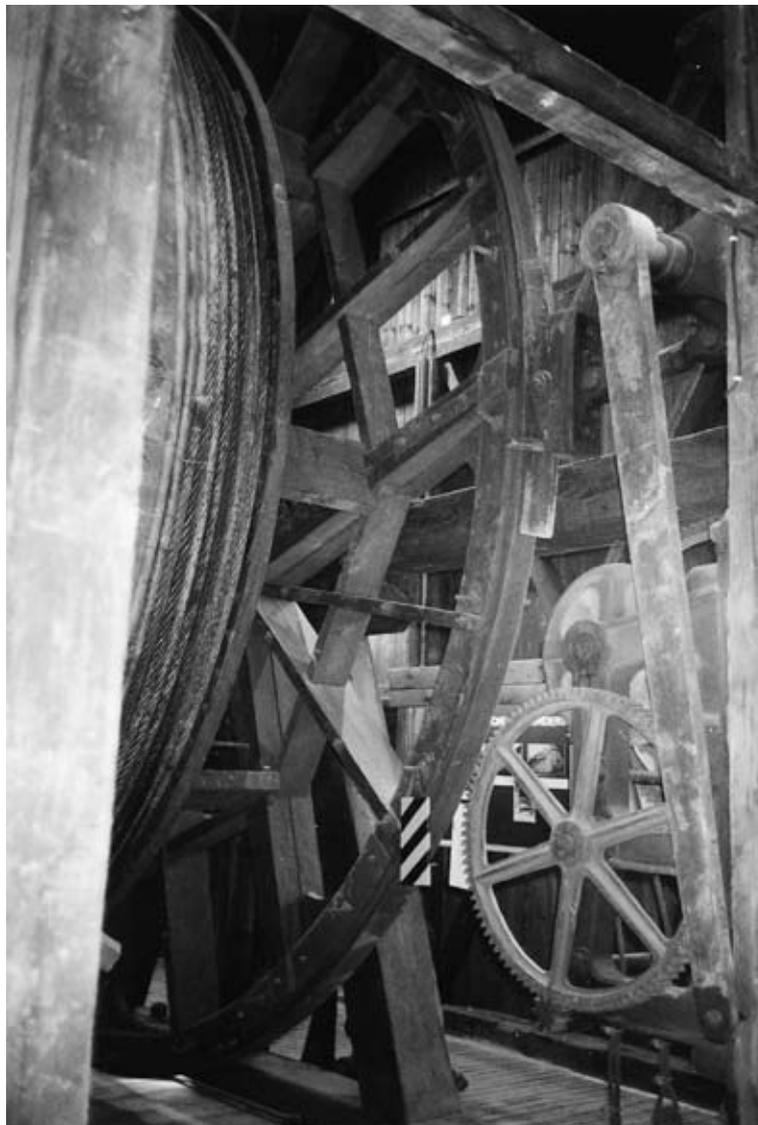
*Abb. 9: Wismath-Aufzug: Neuer Aufstellungsort am Gloriette-Rücken. Im Vordergrund die Seiltrommel, darauffolgend die „Manövrierbremse“ (Backenbremse). Im rechten unteren Bildteil der gußeiserne Haspel zum Nachstellen des Seiles (Foto: Alfred Weiß 1998).*
