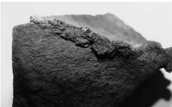
Abb. 2: Ofenstein mit Schlackenaufgabe aus dem Kupferschmelzofen „Versunkene Kirche“, Gemeinde Trieben/Österreich.
