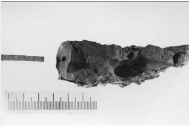
Abb. 4: Makroaufnahmen der Bruchflächen einer dichten Plattenschlacke (links) und einer blasigen Laufschlacke (rechts).
