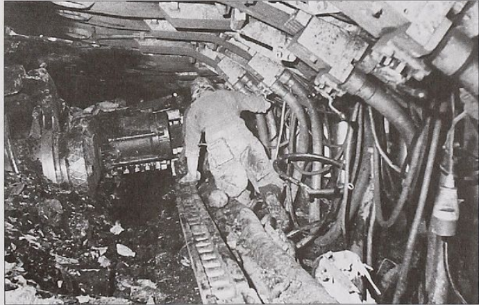
Bild 13: Schildausbau VA. F1/2000 im EDW 150-2 L Streb in Trimmelkam 1992 (Foto Institut für Arbeiterbildung, Wien)
