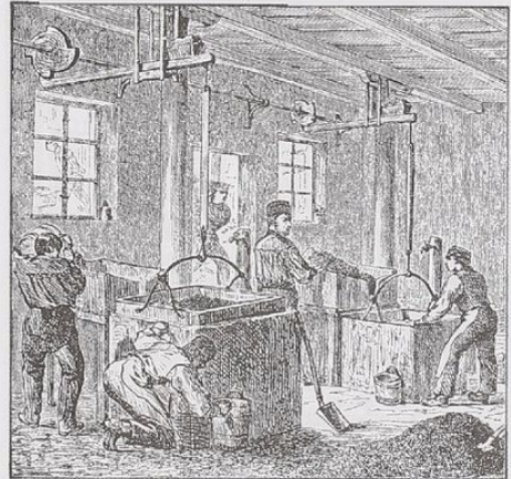
Bild 12: Chargenweises Stauchsetzen mit maschinellem Antrieb im 19. Jhd.
