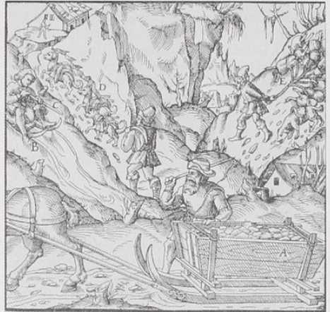
Bild V: Darstellung des Sackzuges als Fördermethode im alpinen Gelände im Hauptwerk Agricolas (6. Buch); (1).
