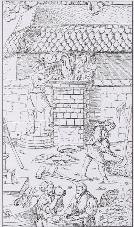
Das Beschieken des Schmelzofens: A Ofen, B Stufen, C Erz, D Kohlen.
