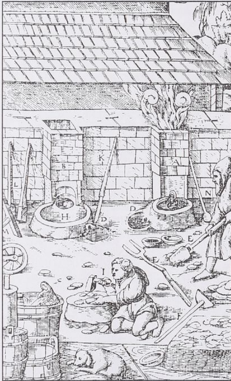
Schmelzöfen: A Ofen mit normalem Vorherd C, B Ofen nach Noricum-Bauart mit Vorherd G im Ofeninneren und Vorherd H außerhalb des Ofens, E Gabel zum Entfernen der Schlacke, F Krücke zum Abziehen des Steins, L Stampfer zum Vorrichten des Ofens, N Schöpfkelle. (G. Agricola, 1556, IX)
