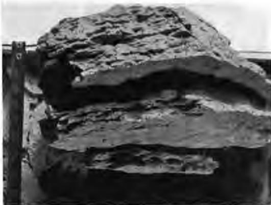
Abb. 2. Lößlehm aus der Lehmgrube Unterweißach, Kreis Bäcknang mit Frostblätterstruktur vom Winter 1953/54. Die Probe ist aus der alten Baggerwand entnommen. Die Blätter liegen parallel zur Baggerwand.
