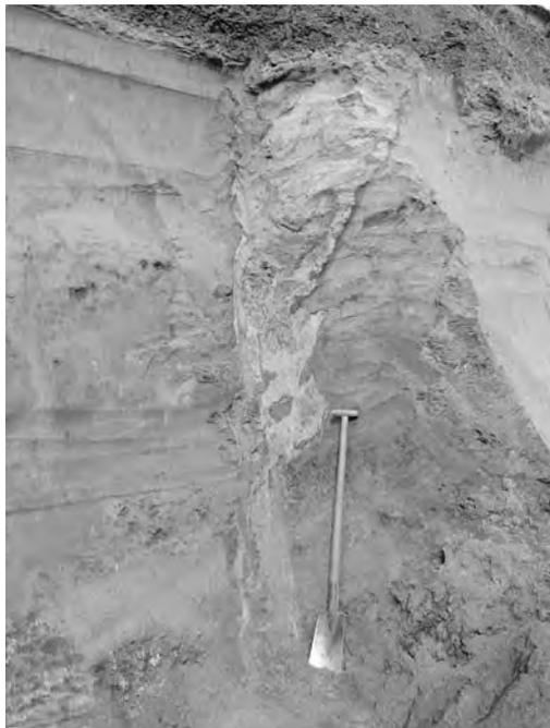
Abb. 7: Mittlerer Eiskeil während der Abgrabung; zentral Schollen von Zechsteinasche in pleistozäner Eiskeilfüllung; links unten im Bild Einschaltungen von Zechsteinkalken in der Kalkasche.
