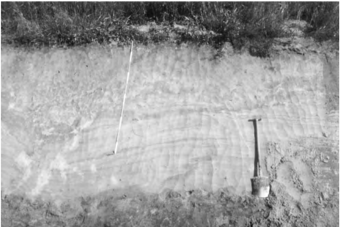
Abb. 3: Braunroter, stark toniger Geschiebelehm (= ostbaltische Fazies der Drenthe-Hauptmoräne) unter gebändertem weichselzeitlichen Flugdecksand; zuoberst Sandlöss. Entwässerungsgraben 1 km westlich Varesesch, TK 25 Goldenstedt Nr. 3216, Foto 1971.
