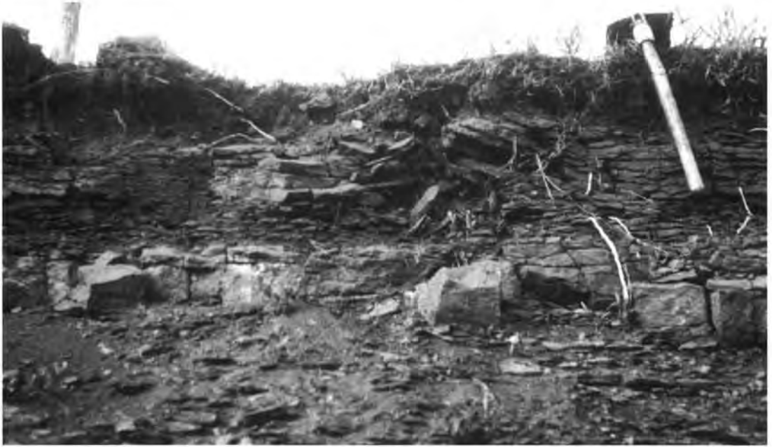
Abb. 3: „Stich“ i. S. KEILHACKS (1931) im ehemaligen Eisensandsteintagebau bei Rottorf am Klei (nordwestl. Helmstedt). Neben dem Stich ein Gelivationshorizont in mürbem rotem Sandstein von ca. 0,5 m Dicke. Foto Sommer 1965.
