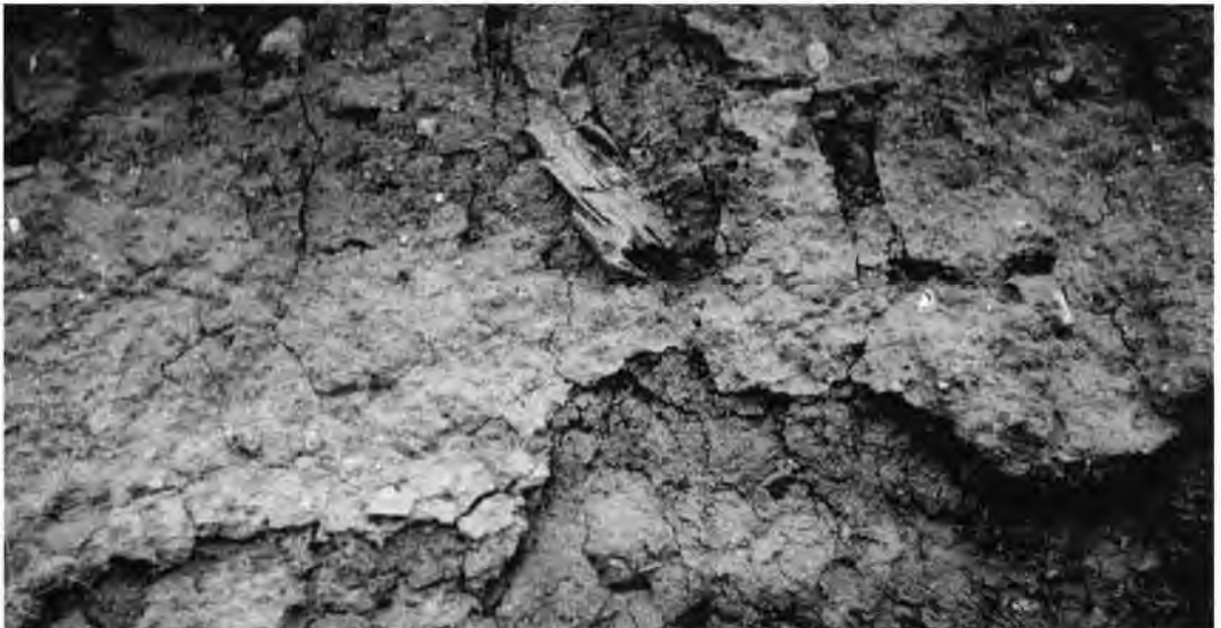
Abb. 1: Ca. 10 cm langes Kongelifraktat (kristalliner Schiefer) in sandig-lehmiger Grundmoräne, ca. 1 m unter der Oberfläche. Ehemalige Tongrube der Stegemannschen Ziegeleigrube am Silberberg südl. Helmstedt (heute Tagebau Helmstedt der Braunschweigische Kohlebergwerke AG). Foto Sommer 1963.
