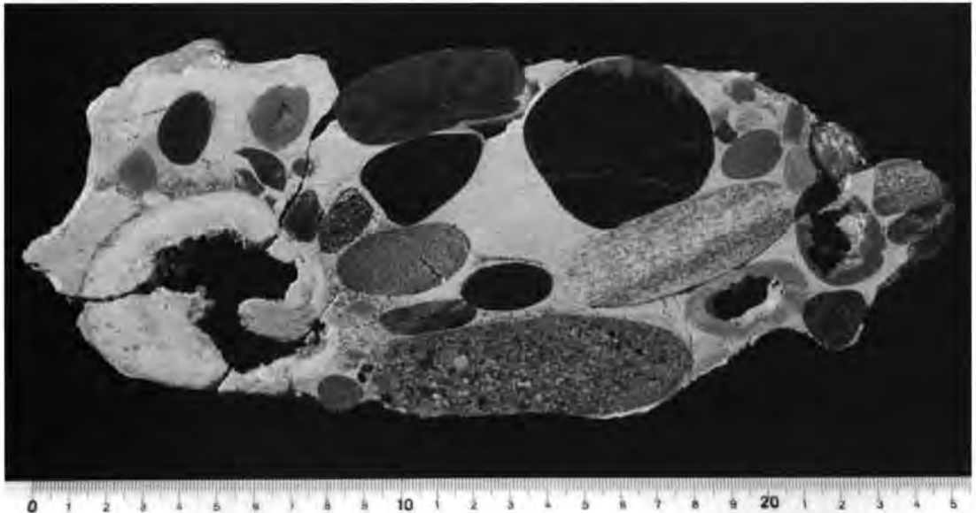
Abb. 5: Angeschliffenes Handstück des zementierten Horizontes aus der Kiesgrube Irchel-Ebni. Laminierte Kalkausscheidungen zwischen den Geröllen. Hohle Gerölle mit sinterartigen Kalkfällungen im Innern.
