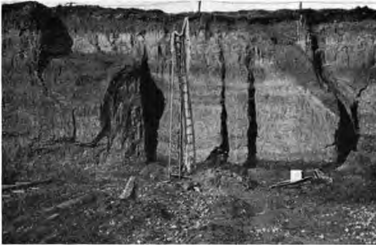
Abb. 1. Nordwand der Ziegeleigrube Blattert in Murr. Die Außenseite des Analysenlackfilms ist durch die Gaze als weißer Streifen rechts neben der Leiter zu erkennen.
