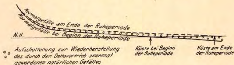
Abb. 1. Schema einer vom Mündungsgebiet aufwärts wandernden Aufschotterung bei gleichbleibendem Meeresspiegel (nach H. QUIRING 1926).
