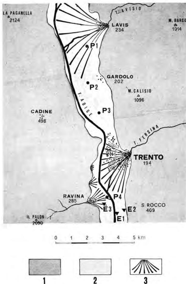
Abb. 1: Das Etschtal im Raum von Trient (1 = Präquartäre Ablagerungen; 2 = Postglaziale Talverschüttung; 3 = Schwemmkegel; P = Bohrbrunnen; E = Geoelektrische Meßpunkte).
