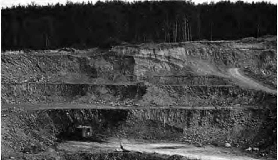
Abb. 1: Basaltbruch der Fa. Nickel, Dreihausen, Gemeinde Ebsdorfer Grund, Kreis Marburg. Blick auf die nördliche Abbauwand, ca. 300 m NN. In der Mitte des Bildes ist zwischen der Oberfläche und der obersten Abbausohle der Rest der quartären Hohlraumfüllung zu erkennen. Eine zweite, geringmächtige ist oben rechts im Bild zu beobachten.
