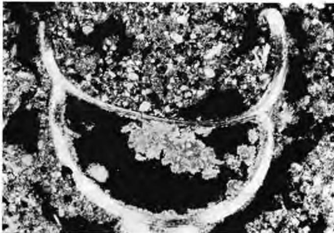
Abb. 7. Löß unter dem „F<sub>3</sub>“-Boden im Lößprofil von Mende. — In Teilen angelöster Conchylie, daneben sowohl innerhalb wie außerhalb sekundär ausgefüllte Kalzitmikrolithen, Anzeichen für eine hohe Karbonatdynamik. (+ N, Vergrößerung 50-fach.)
