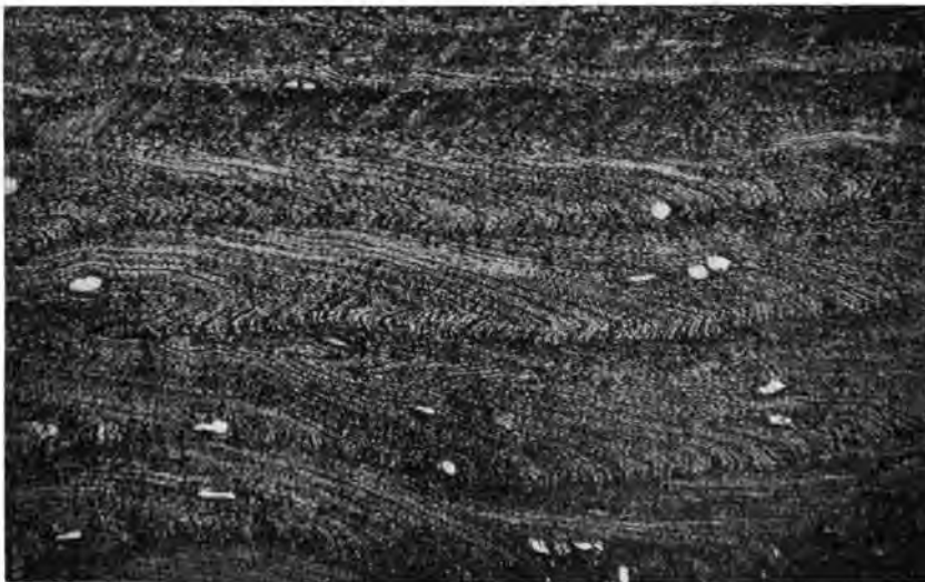
Abb. 6. Querschnitt durch den stark gepreßten Holzrest (Gro 2595). Beide Holzaufnahmen: Institut für Holzforschung und Holztechnik, Universität München (Direktor: Prof. Dr.ing. F. KOLLMANN).
